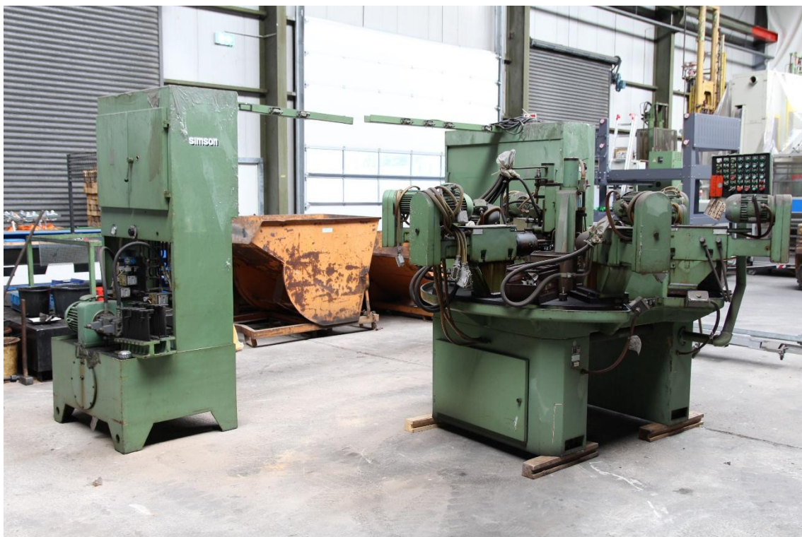
Seitliche Maschinenansicht mit Hydraulikaggregaten und integrierten Schaltschränken
